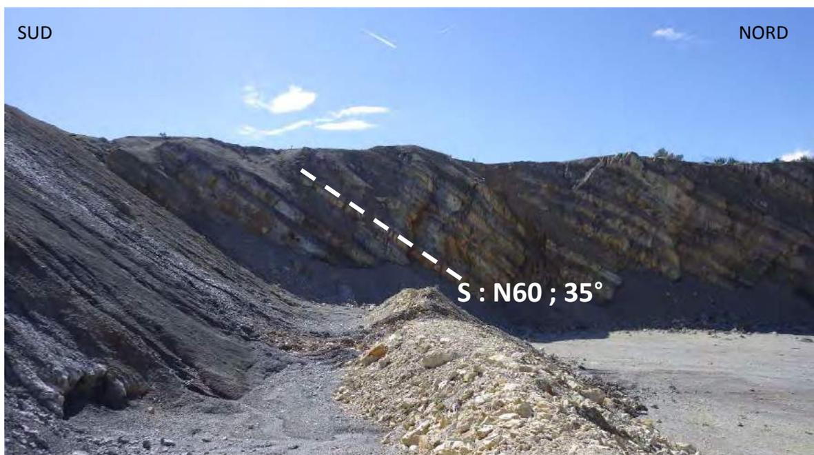
*Alternances de bancs marneux indurés (0,5m) et de bancs plus altérés présentant des traces d'humidités (0,3m).*
